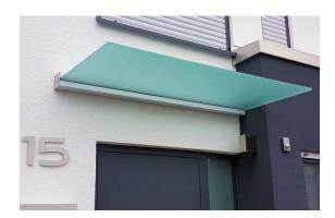
Das Vordachsystem ACR Line weist eine klare, moderne Ästhetik auf. Die puristische Konstruktion besteht aus einer durch- gehenden Wandklemmleiste und besonders reißfestem Spe- zialglas (SentryGlas). Durch die Kombination von Profil und SentryGlas wird die außerordentliche Tragkraft des Daches erzielt und eine trägerlose Dachausladung bis 1.100 mm er- möglicht. Mit Hilfe einer wandseitig montierten Keilleiste er- hält das Dach eine 3° oder 5° Neigung.
